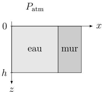
On s'intéresse à un pan de mur vertical d'une piscine de profondeur  $h = 4$  m. Le pan de mur est large de  $L = 10$  m dans la direction ( $Oy$ ).
