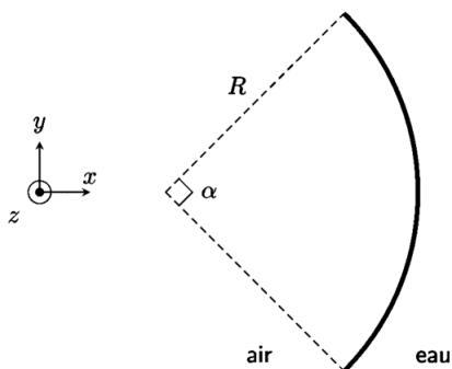
Un barrage voûte est ainsi nommé en raison de sa forme arquée caractéristique. La forme courbe de ces barrages permet de reporter les efforts dus à la poussée de l'eau sur chaque côté des rives. On modélise un tel barrage par un quart de cylindre de hauteur  $H = 135$  m, rayon  $R$  et d'ouverture  $\alpha = \frac{\pi}{2}$ .
